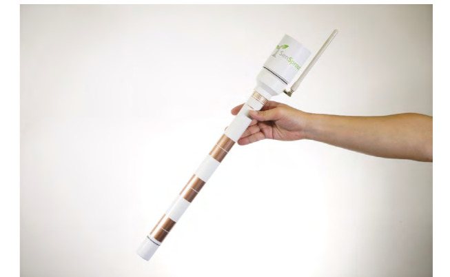
図 2. 実証実験で使用している低価格土壌水分センサ
